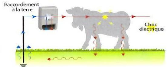
Fig. 4 - Installation de l'électrificateur
